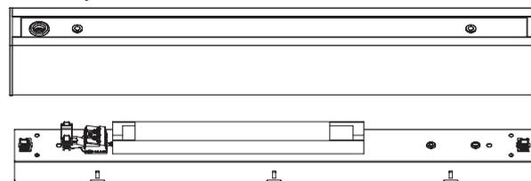
E / Clipper la platine dans le corps en appuyant uniformément sur toute sa surface afin qu'elle rentre bien droite dans le corps. Ne pas forcer. Pendant cette manœuvre, pousser sur le câble d'alimentation afin d'éviter qu'il se coince sous la platine. Vérifier le bon positionnement de la platine dans le corps.
