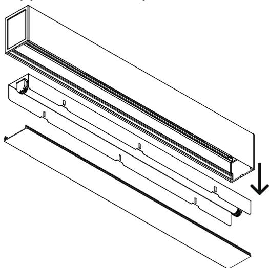
C / Passer le câble d'alimentation (Ø 11 mm maximum) dans l'appareil par le trou du passe-fils en le rentrant d'environ 50 mm. Fixer le corps au plafond avec 2 vis Ø 4 (non fournies) via les inserts au fond du caisson.
