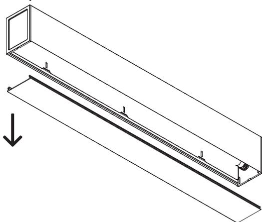
B / Retirer la platine en la faisant glisser avec les mains vers l'extérieur de l'appareil. Si besoin, l'enlever à l'aide d'un tournevis plat en détachant LÉGÈREMENT la platine du corps pour l'extraire (en 3 points : au milieu de l'appareil et à chaque bout).
